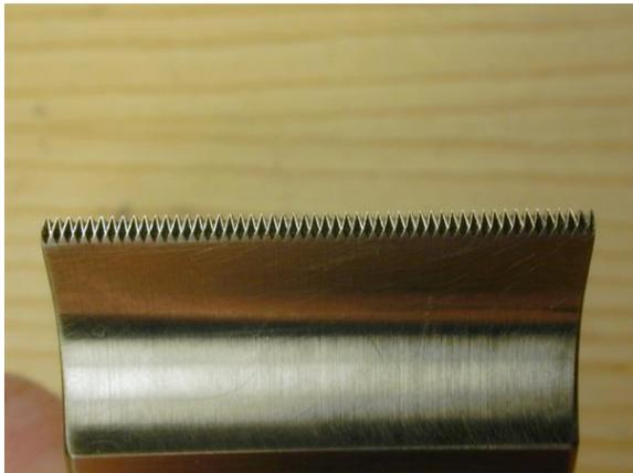
Die Sonotrode wurde mit einer feinen Zickzack-Kontur mit 0,5 mm Teilung, 1 mm Höhe versehen. Damit steigt die Nahtlänge auf reichlich das Vierfache und damit auch die Nahtfestigkeit. Auch die Weiterreißfestigkeit steigt dadurch erheblich.
