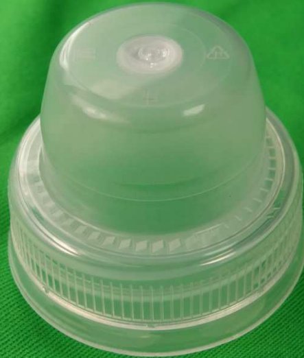
Dosier-Schraubverschluss mit PTFE-Membran geschnitten
